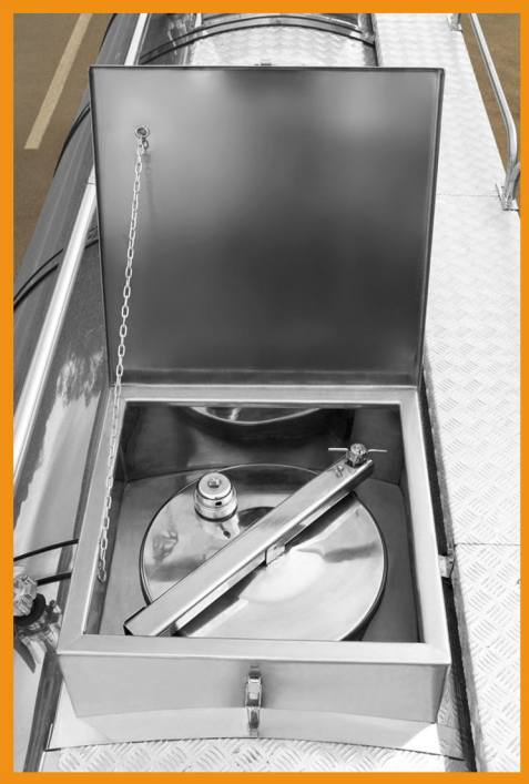
Escotilha de visitação tanque interno.
